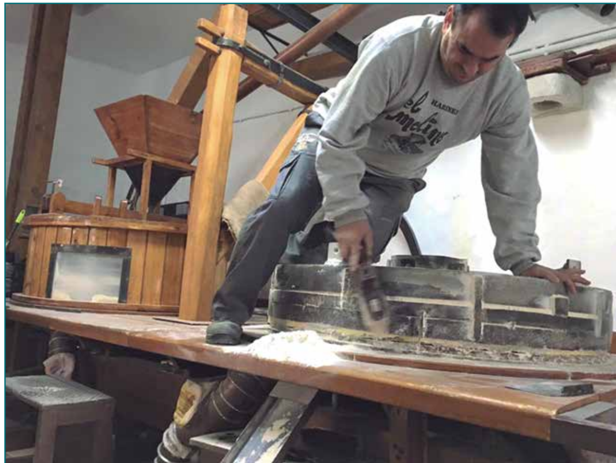
La piedra de moler, de 1812, sigue picándose manualmente. Bartolomé Méndez, cuarta generación de molineros, es quien se encarga de ello. Foto: Harinera El Molino.
