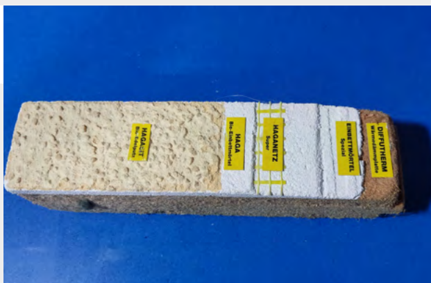
Muestra de SATE fabricado con aislante de fibra de madera
