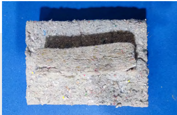
Aislante térmico fabricado con celulosa
